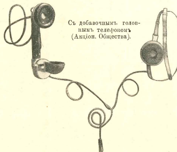
Рис. 9. „Патрульный кавалерійскій“ Микро-телефонъ (вся станція, кромѣ элементовъ) съ его шнуромъ, отдѣлен- ный отъ батарейной сумки.
